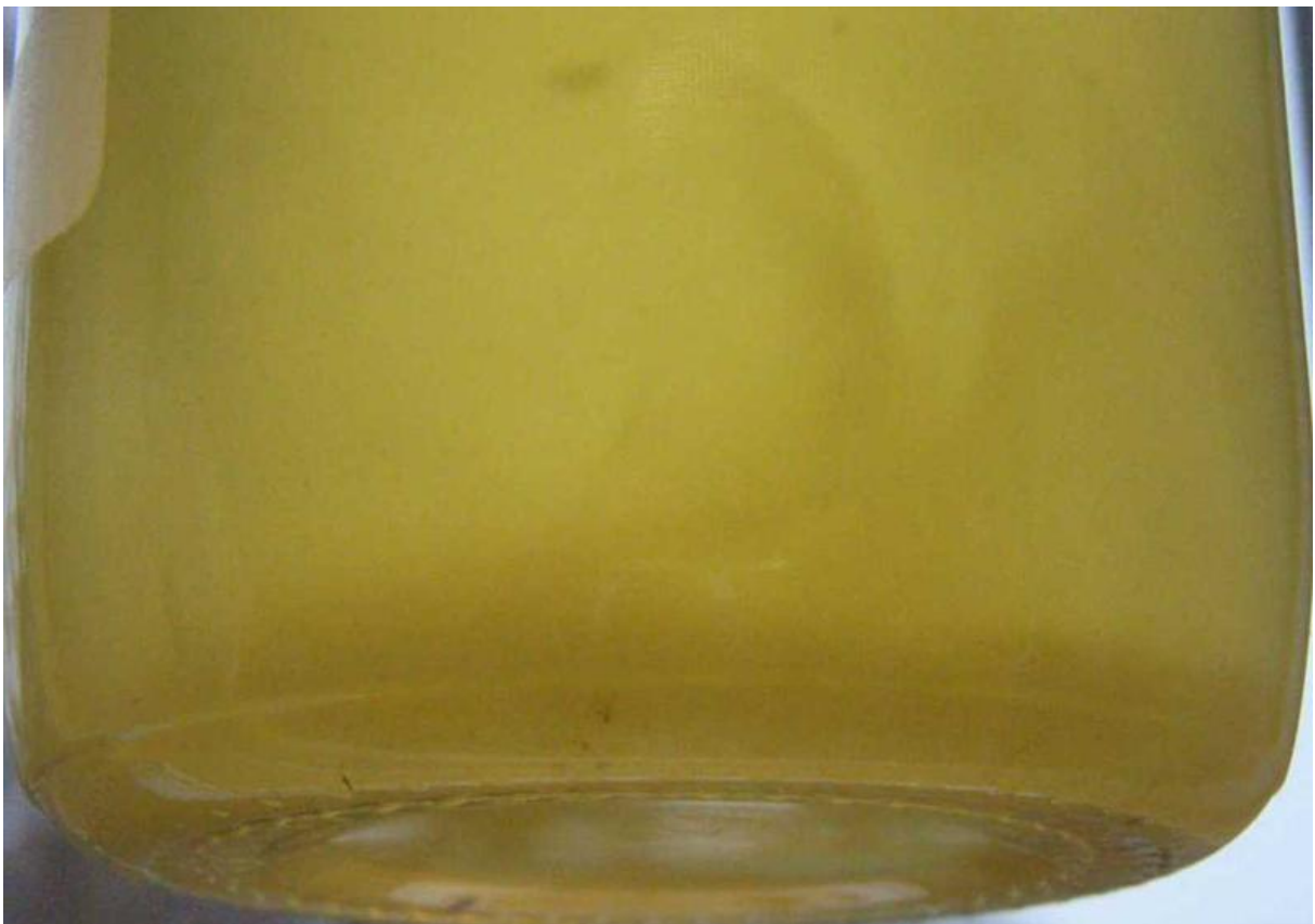
Abbildung 1: B20-Probe, ca. 2 Jahre in einem Edeltank gelagert
