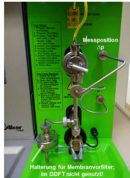
Heizstabsektion, fertig montiert
