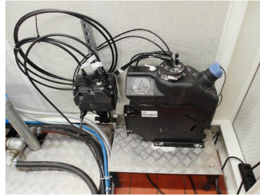
Abbildung 4-6 und Abbildung 4-7: AdBlue-Dosierung mit Kühlung, Mischerstrecke und Tank mit Pumpe
