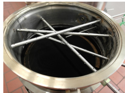
Abbildung 4-8 und Abbildung 4-9: Bestückung der Messzylinder mit Sensoren für T, p und Abgas
